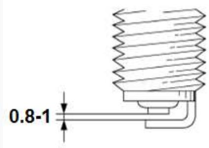
باید توجه داشت که فاصله دهانه شمع بین 0.8 تا 1 میلی متر باشد ، آن را با فیلر تنظیم کنید.
