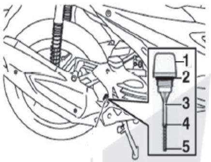
حال گیج را با یک تکه پارچه تمیز پاک کنید تا روغن از روی سطح میله گیج پاک گردد. مجدد گیج را در جای خود قرار دهید بدون آن که آن را بپیچید تا بسته شود.
