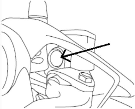
در کنار هر مخزن یک صفحه نشانگر میزان روغن وجود دارد که می توان سطح روغن ترمز در داخل مخزن را مشاهده کرد. در صورت نیاز به تزریق مجدد و یا فرا رسیدن دوره تعویض روغن ترمز از روغن پیشنهاد شده شرکت استفاده نمایید.
