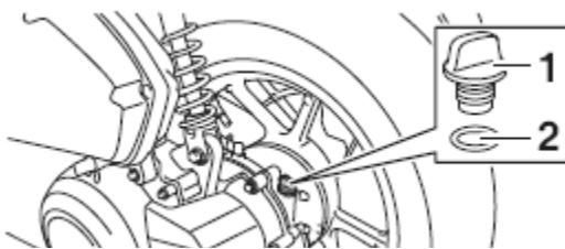
برای کار کردن روان و درست قوای محرکه در این موتور از روغن گیربکس استفاده شده
